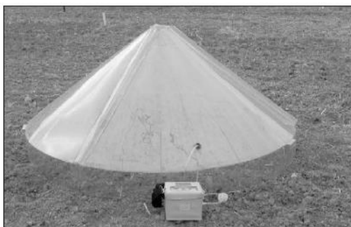
Figura 1. Estrutura em PVC e analisador portátil.
