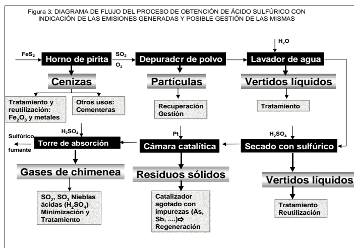
Figura 2. Diagrama de flujo para la obtención de ácido sulfúrico.
