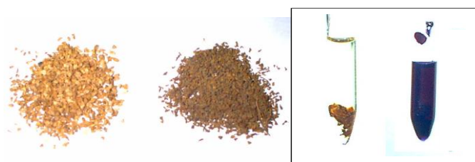
Figura 1. Aspecto de los granulados natural y modificado (S1 y S1-D3) i ejemplo de test de ninhidrina, positivo frente a la presencia de grupos amino primarios (NH 2 ).
