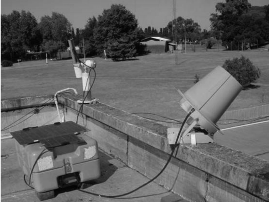
Figura 2. Foto del fotómetro solar instalado en el CEILAP-BA (Buenos Aires). Se pueden ver los paneles solares y la caja estanca que contiene el transmisor a la izquierda de la fotografía y la antena cónica a la derecha.
